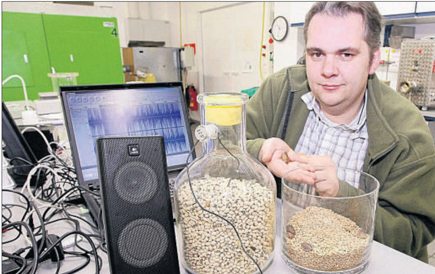
Lauschangriff: Im Labor versucht Dr. Uwe Richter, die arttypischen Geräusche verschiedener Lagerschädlinge zu ermitteln. Foto: Schröter
